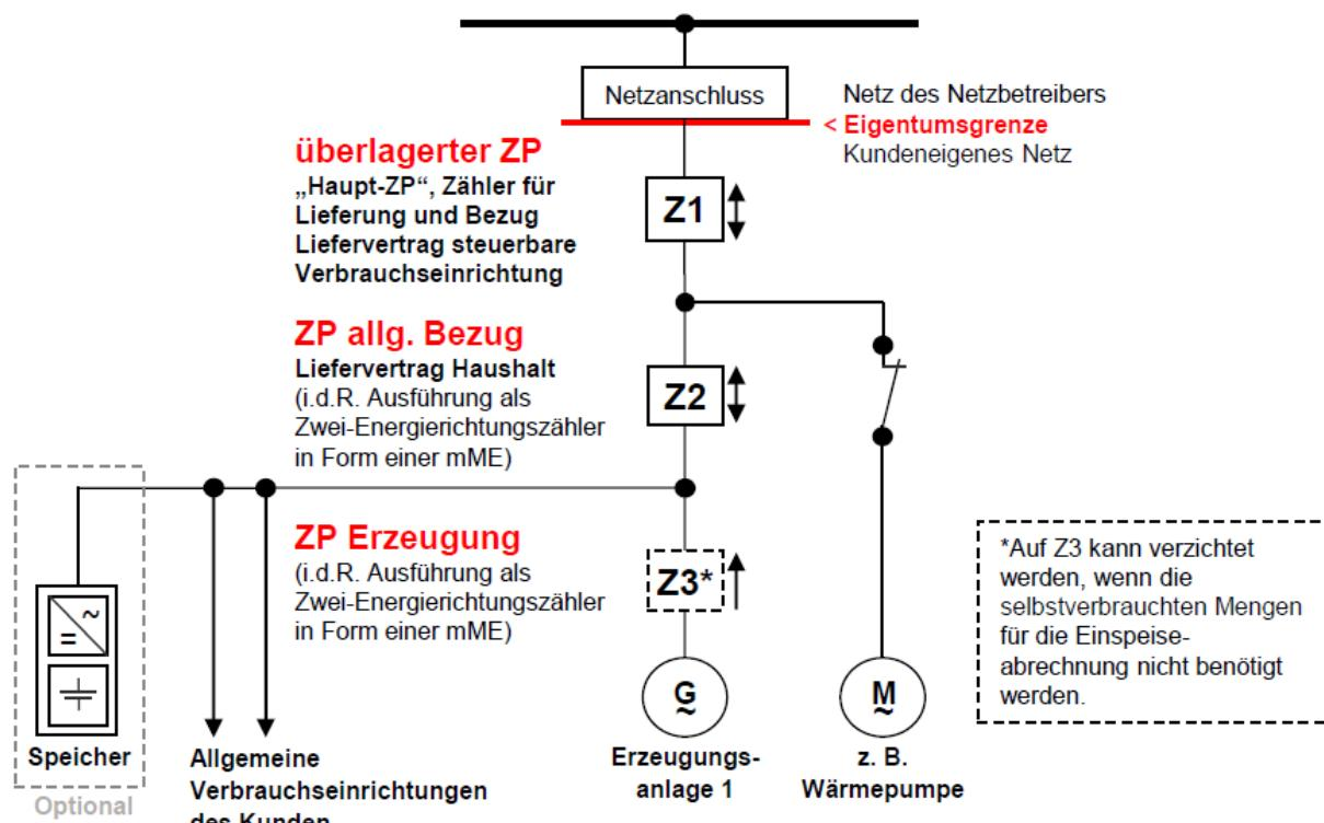
**Z1 bis Z3 müssen einheitlich als SLP-Zähler ausgeführt werden!**
