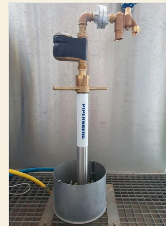
Standrohr für die Bauwasserversorgung
